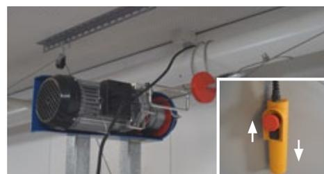
2900546 Moteur électrique pour relevage centralisé
