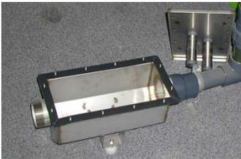
Lorsque les flux de l'alimentation de la cuve de mélange passent à travers le piège à pierre, des petits cailloux s'installent au fond.
