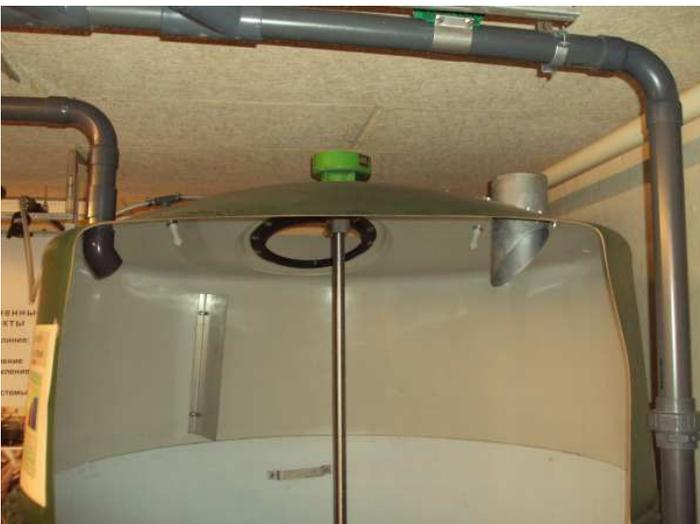
Cela ne dépend pas du nombre de composants (ou de silos) que vous avez, les composants viennent des silos dans la cuve de mélange du tuyau principal. Une spire flexible vient du fond des silos qui sont connectés à un tuyau commun, connecté lui-même en haut de la cuve de mélange. L'ordinateur donne l'ordre au système de
