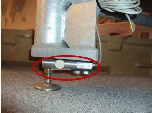
Les détecteurs de poids sont localisés aux pieds de la cuve. En d'autres mots, la cuve est un bol pesant. Le poids est affiché sur un ordinateur.
