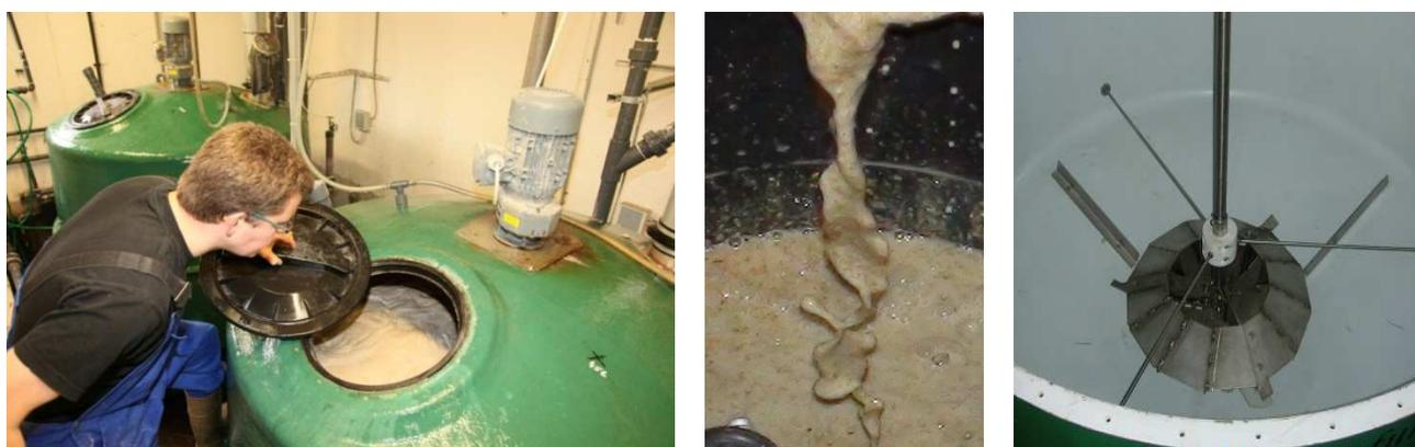
Ces qualités sont gardées par un bon mélange des composants de la nourriture. La cuve de mélange est faite avec de résistantes fibres de verre. La paroi intérieure de la cuve est parfaitement lisse et évite les dépôts d'aliments non désirés et permettent, de la même manière, un nettoyage simple et rapide. La cuve est équipée d'un mixeur spécial et d'un système de nettoyage automatique.
