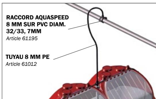
L'abreuvement est composé d'une tuyauterie flexible qui se clipse sur le couvercle du nourrisseur. La tuyauterie peut être fixée sur les descentes d'aliment simplifiant le nettoyage et l'installation.
