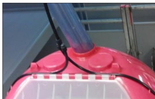
Le couvercle possède trois empreintes pour optimiser le remplissage de la trémie même si on utilise plusieurs chaînes d'alimentation. La forme facilite le remplissage au maximum avec un dosage exact, même en petites quantités.
