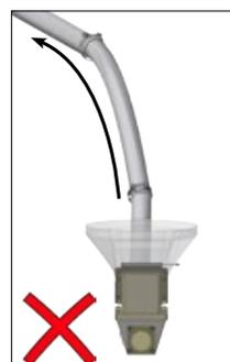
Pour limiter l'usure, l'orientation du tube doit se faire par la droite.
