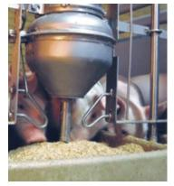
La trémie du FUNKIMAT est conçue pour une utilisation totale du volume et permet une large plage de remplissage. La trémie, étanche à la brumisation, peut être remplie par 3 circuits différents.
